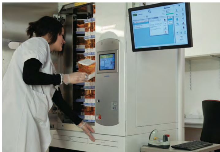
Préparation des semainiers pour les EMS partenaires de la PHEL à l'aide d'un automate Baxter FDS Proud II
