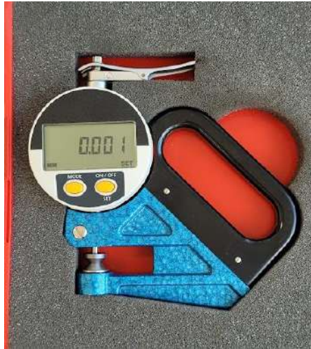
Figure 40. Photo de la jauge d'épaisseur numérique utilisée pour mesurer l'épaisseur des films
