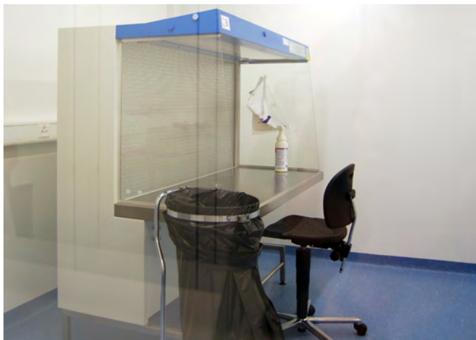
Local à atmosphère contrôlée pour la préparation de produits stériles
